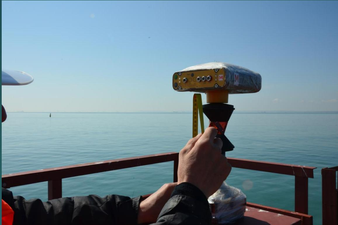
ИЗМЕРЕНИЯ НА ПУНКТАХ ВЫПОЛНЯЛИСЬ В СТАТИЧЕСКОМ РЕЖИМЕ ДВУХЧАСТОТНЫМИ ДВУХСИСТЕМНЫМИ (GPS/ГЛОНАСС) СПУТНИКОВЫМИ ПРИЕМНИКАМИ TOPCON HIPER GD (ТОЧНОСТЬ СПУТНИКОВЫХ ОПРЕДЕЛЕНИЙ ПЛАНОВОГО ПОЛОЖЕНИЯ ПУНКТОВ НЕ БОЛЕЕ  $MXY = 3 \text{ мм} + 0,5 \text{ мм} * D(\text{км})$ ), ГДЕ D – ДЛИННА БАЗОВОЙ ЛИНИИ В КМ.
