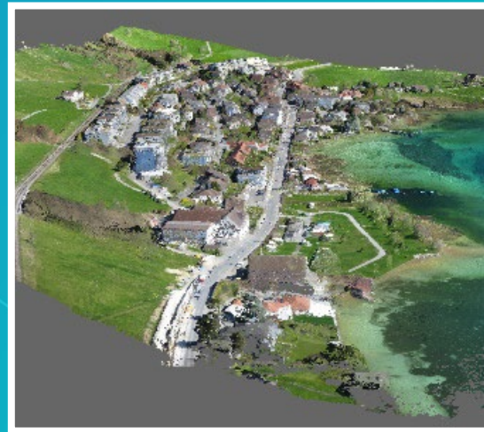
2. Создание плотного облака точек
