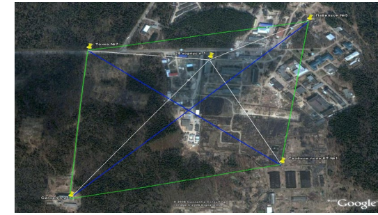
Лазерный эталон сравнения и эталонные базы в диапазоне 24 м – 3000 м. Среднее квадратическое отклонение результата измерений 0,7 мм
