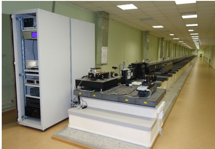
Транспортируемый лазерный интерферометр. Среднее квадратическое отклонение результата измерений 2,5 мкм
